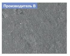
3000 – кратное увеличение показало, что структура поверхности костного трансплантата создает идеальные условия для крепления и роста клеток. Структура поверхности A-Oss схожа с поверхностью ксенографта от производителя А – продуктом с доказанной эффективностью при регенерации костных тканей. Тогда как продукт от производителя В сильно отличается по своей структуре от костных тканей человека
